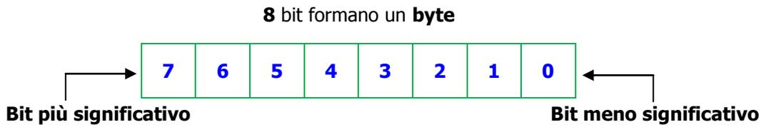
Nell'esempio sottostante all'interno di ogni casella, in base alla posizione, sono stati inseriti i valori decimali che rappresentano i bit, quando il loro stato è diverso da zero.
