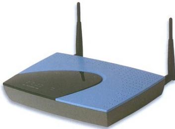
Il **modem** (da **MO**dulatore/**DE**Modulatore) serve a convertire i dati dal formato digitale (computer) a quello analogico (linea telefonica) e viceversa. Si comprende che, questa apparecchiatura, è utilizzata per il collegamento in una rete geografica (computer o reti di computer molto distanti tra loro) o in INTERNET. A seconda del tipo di linea telefonica a disposizione possiamo definire i seguenti tipi di
