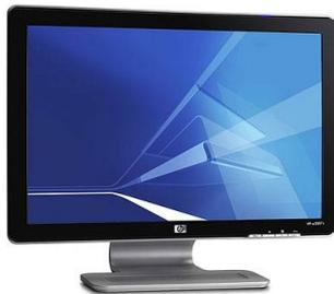
Il **Monitor** è l'interfaccia principale con cui l'operatore umano è in grado di controllare l'attività del computer. Originariamente erano costituiti da tubi catodici (CRT), attualmente sono sempre più diffusi gli schermi piatti a cristalli liquidi (LCD). Per specifiche applicazioni possono essere utilizzati monitor sensibili al semplice tocco delle dita (in questo caso diventano periferiche sia di input che di output).
