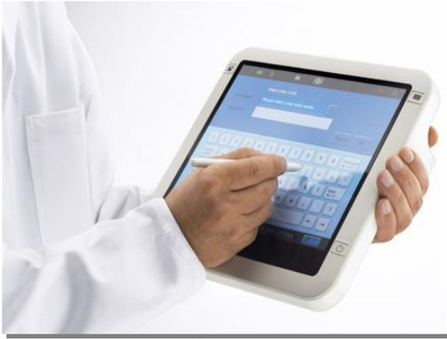
Il **Tablet PC** (letteralmente PC tavoletta) è un computer portatile che, tramite un digitalizzatore, consente di scrivere, manualmente, direttamente sullo schermo utilizzando apposite penne (chiamate Stilo) o toccandolo con le dita. In pratica il tablet pc è un normale portatile che, utilizzando lo schermo tattile (e associati programmi d'interfacciamento), fa a meno di tastiera e mouse.
