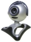
Una **webcam** è una telecamera di ridotte dimensioni che non dispone di un proprio sistema di memorizzazione delle immagini, ma trasmette semplicemente ciò che riprende in forma digitale, attraverso un'interfaccia, a un computer.
