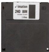
Il **floppy disk** nasce alla fine degli anni ‘60 in casa IBM per contenere il software necessario ai mainframe della serie 370. Esternamente il floppy disk si presenta come un contenitore di plastica quadrato contenente un dischetto sottile e flessibile, da cui il termine “floppy”, di materiale sintetico in cui sono memorizzati i dati in un insieme di tracce circolari concentriche ognuna delle quali è poi suddivisa in un certo numero di settori.
